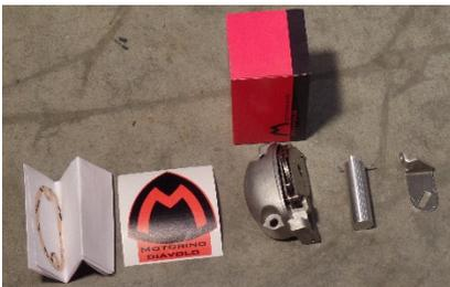
Einbau nur für versierte Bastler oder den Handel. Wir empfehlen neue Schaltzüge mit Teflon-Seele, außerdem muss der Drehgriff leichtgängig sein.
